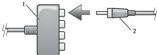
1 Komponenten-Video-Adapter 2 S/PDIF-Digital-Audio-Kabel
