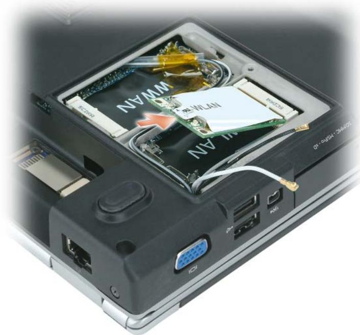
**➔ HINWEIS:** Um eine Beschädigung der WLAN-Karte zu vermeiden, sollten Sie das Kabel nie unter der Karte platzieren.
