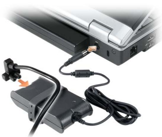
**⚠ VORSICHT:** Der Netzadapter funktioniert mit allen Steckdosen weltweit. Die Stecker oder Steckdosenleisten können jedoch unterschiedlich sein. Wird ein falsches Kabel verwendet oder dieses nicht ordnungsgemäß an die Steckerleiste oder die Steckdose angeschlossen, können ein Brand oder Schäden im System verursacht werden.
