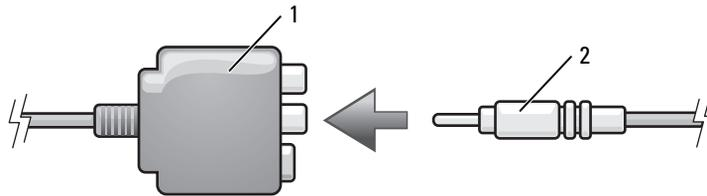
1 Mischsignal-Videoadapter    2 Mischsignal-Videokabel
