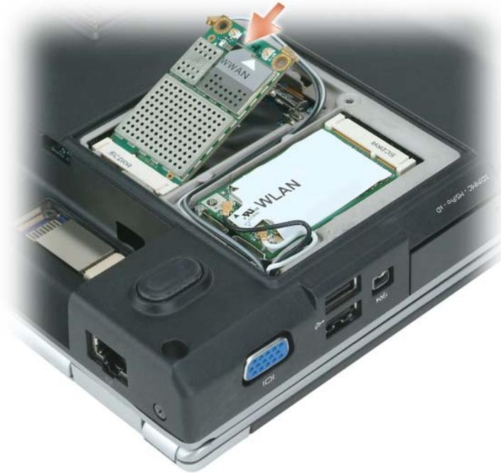
➔ **HINWEIS:** Um eine Beschädigung der WWAN-Karte zu vermeiden, sollten Sie das Kabel nie unter der Karte platzieren.
