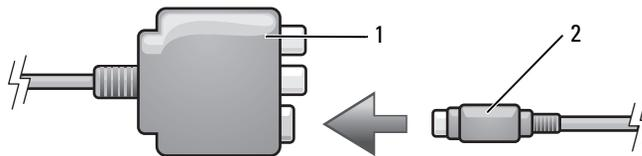
1 Mischsignal-Videoadapter    2 S-Video-Kabel
