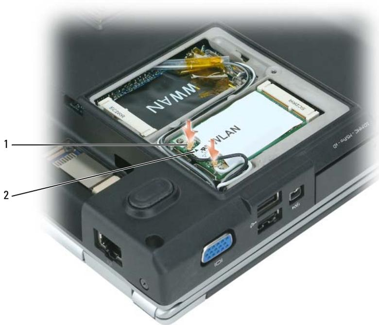
1 Antennenkabelanschlüsse (2) 2 Dreiecksmarkierungen (2)
