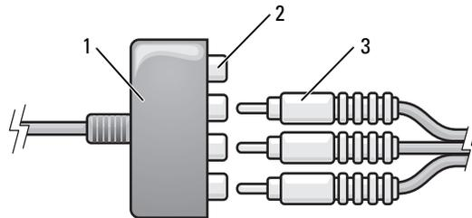
1 Komponenten-Video-Adapter 2 Komponenten-Video-Ausgänge 3 Komponenten-Video-Kabel
