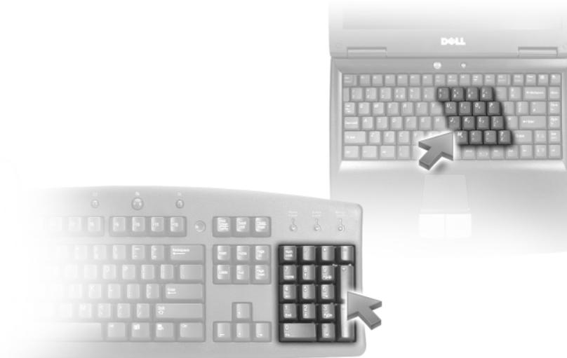
Der numerische Tastenblock funktioniert genauso wie der numerische Tastenblock auf einer externen Tastatur. Jede Taste auf der Tastatur besitzt mehrere Funktionen. Die Zahlen und Symbole des numerischen Tastenblocks sind in blauer Schrift rechts auf den entsprechenden Tasten angegeben. Wenn Sie eine Zahl oder ein Symbol eingeben möchten, drücken Sie <Fn> und die gewünschte Taste, nachdem Sie den Tastenblock aktiviert haben.
