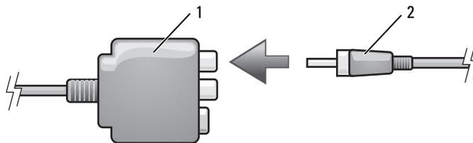
1 Mischsignal-Videoadapter    2 S/PDIF-Digital-Audio-Kabel
