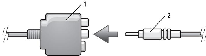
1 Mischsignal-Videoadapter 2 Mischsignal-Videokabel
