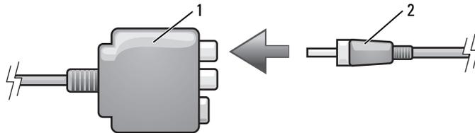
1 Mischsignal-Videoadapter 2 S/PDIF-Digital-Audio-Kabel
